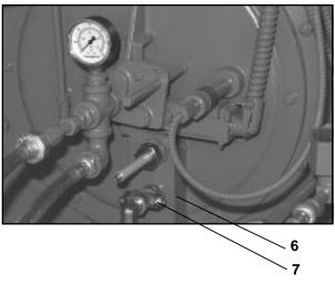
6. GAS PILOT ASPIRATOR 7. GAS PILOT ADJUSTING COCK
